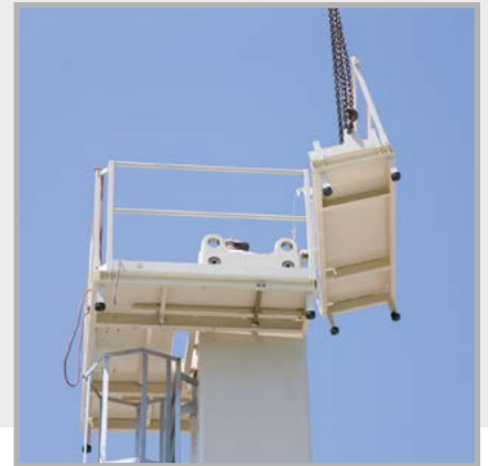
Конструкция стрелы МХ с дополнительной защитной рабочей площадкой
